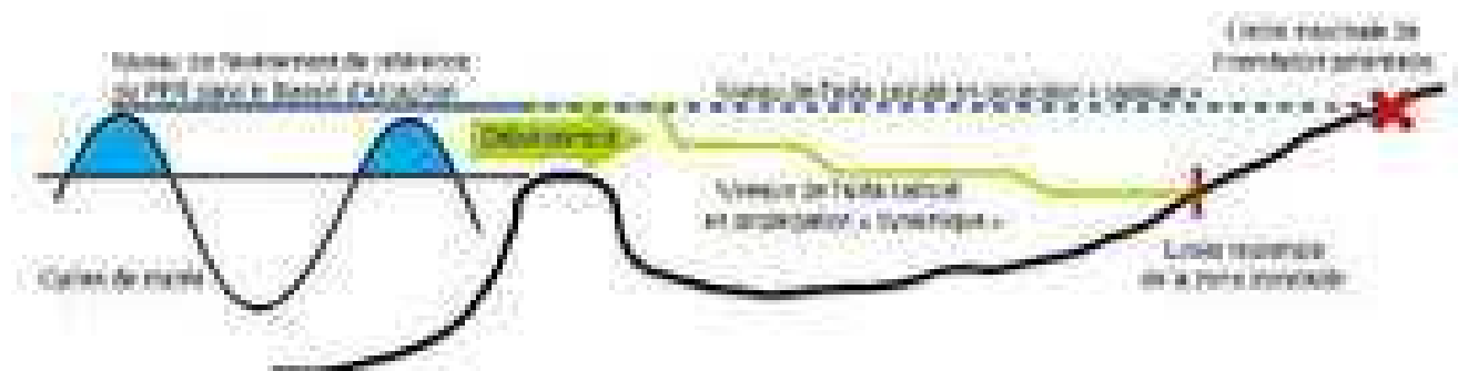
Illustration 6 Schéma de principe de la méthodologie employée pour la propagation de la submersion marine. Le niveau de l'événement de référence (bleu continu) n'est pas simplement projeté de façon « statique » et continue sur la topographie (bleu pointillé) mais bien propagé suivant une dynamique de submersion (vert)
