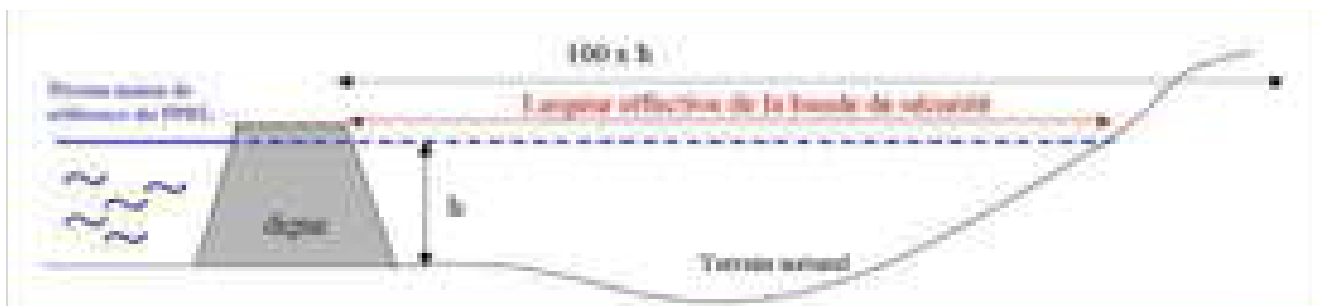
Illustration 8 Définition de la bande de précaution derrière un ouvrage
